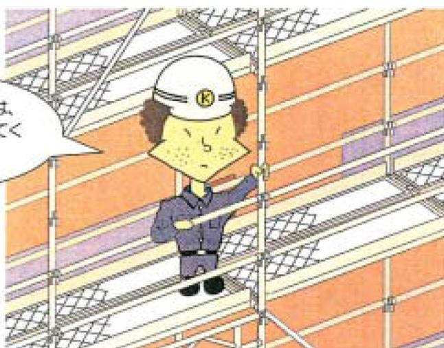
緊結部付布材は、次のいずれかの位置の前踏み、後踏みの両構面に設けること。
